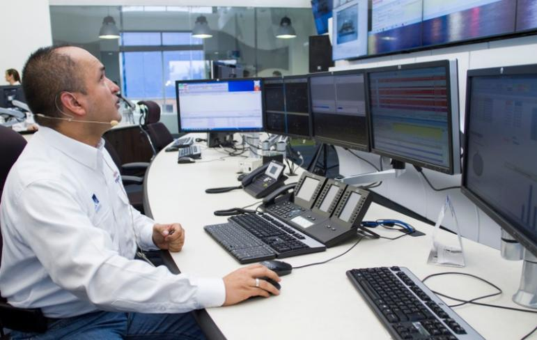
Innvector provee consolas de de última tecnología para realizar seguimientos de labores críticas, cuentan con un puesto de trabajo ergonómico, un núcleo tecnológico, gestión inteligente de cableado, control automático de altura y una serie de pantallas de alta definición con bajo consumo energético.
